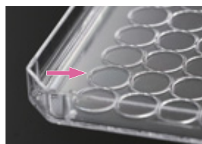
板盖内侧凸起圆形环可有效防止培养基污染和蒸发损耗
