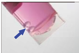
保存管内两粒玻璃珠使病毒样本更易洗脱，利于更多样本释放放入保存液中。
