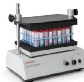
工作实例二 批量混匀：30ML 病毒采样管、50ML 离心管。
