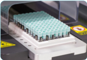
抽屉式输入输出口，开盖过程避免样品污染的风险。
