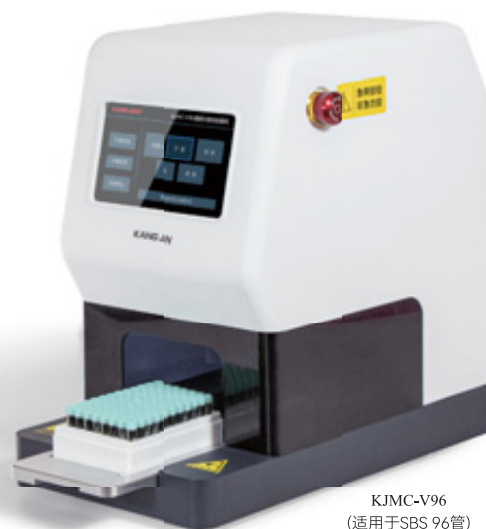
抽屉式输入输出口，开盖过程避免样品污染的风险。
